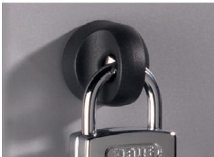
Der C + P Sicherheits-Drehriegel kann nicht überdreht werden, weil er im geschlossenen Zustand „durchdreht“, also keinen Angriffspunkt bietet! Erst mit dem Entfernen des Vorhangschlosses rastet der Schließzylinder ein, und die Tür kann durch einfache Drehung des Verschlussknopfes geöffnet werden. Für Schloss-Bügelstärke 6-8 mm.
